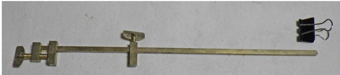
右端のWクリップは、ゼンマイの先を押さえるつもりで用意したものです。ただ実際に始めてみると、長さが全く足りない事、ゼンマイが予想以上に強力でWクリップでは抑えきれない事が分かりました。そこでハタガネを2本つないでクランプで締め付け、ギヤボックスに取り付けました。右のハタガネの先で、ゼンマイを押さえることも出来ます。
