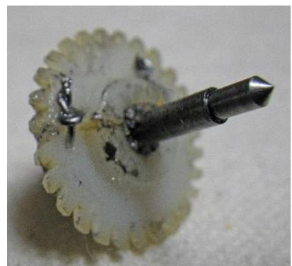
全体がしっかりした造りで、ゼンマイも長大、歯車も分厚いものでした。その中でただ一つ、速度調整部分のギヤだけがプラスチック製で、真二つに割れていて、既に接着されていました。しかし接着だけでは弱く思えたので、0.5mmのステンレス線で、2か所結束しました。(このギヤはすり減っていて、また割れを接着した結果の、歪みが見られました)他に傷みなどは見られなかったので、組み立てにかかります。
