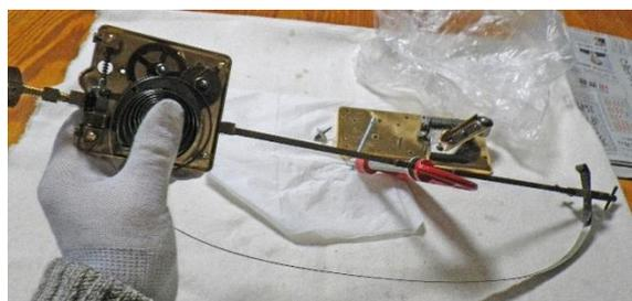
左が実際の作業中の様子です。下半分に弓のように映っているのがゼンマイです。ゼンマイは油脂でツルツルしているから、手袋をして弾力を抑え込みながら、力ずくの作業、指先もなかなか疲れました。
